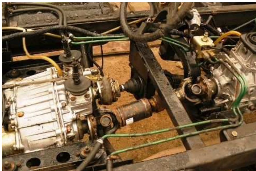
Rys. 3. Elementy układu napędowego: po prawej stronie skrzynia biegów, a po lewej skrzynia rozdzielcza
