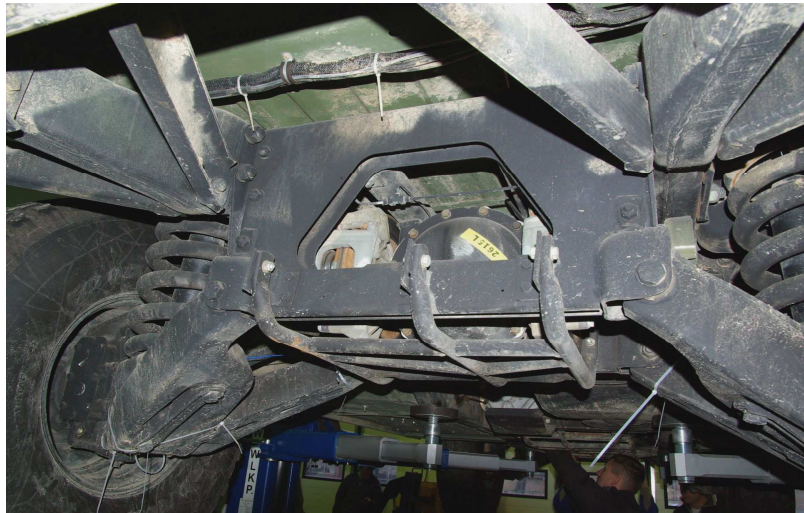
Rys. 10. Elementy zawieszenia tylnej osi. Widoczna obudowa przekładni głównej i zaciski hamulców schowane we wnętrzu ramy
