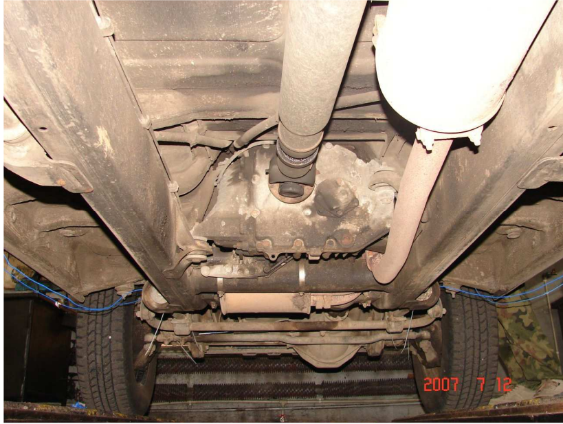
Rys. 4. Wygląd przedniej części ramy dla pojazdu z rozstawem osi 2850 mm Źródło: Materiały własne
