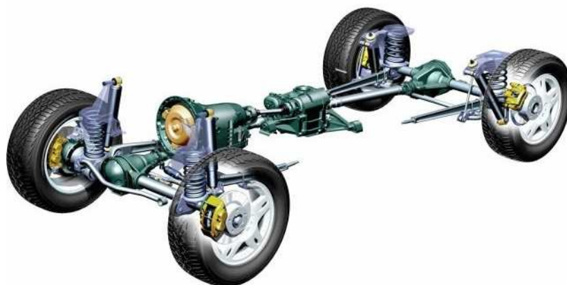
Rys. 6. Rozmieszczenie elementów zawieszenia i układu napędowego
