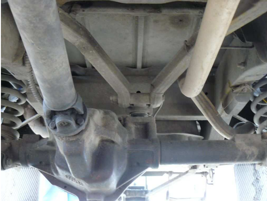
Rys. 9. Zintegrowane górne wahacze wleczone w zawieszeniu tylnej osi
