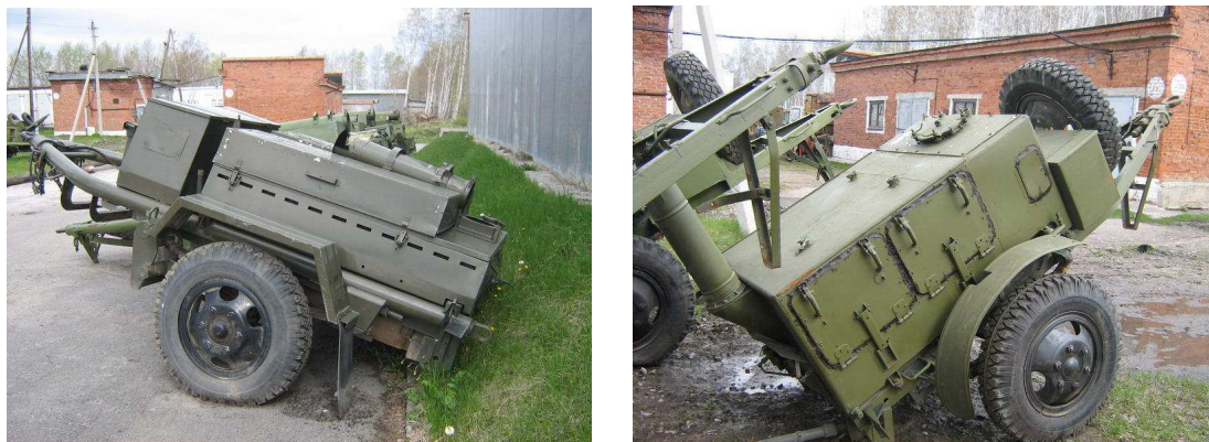
Rys. 9. Rosyjskie kuchnie polowe (zdjęcie z lewej strony - kuchnia KP-130 27 , na prawo - kuchnia KP-125)
