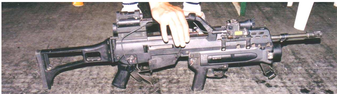
Rys. 5. Pierwotna wersja 5,56mm karabinek automatyczny G36 z podwieszonym 40 mm granatnikiem AG36 i modułem wskaźnika laserowego LLM01
