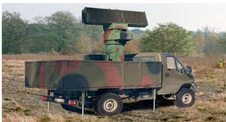
Fot. 9. Radar trójwspółrzędny CNPEP Radwar MMSR próbnie osadzony na podwoziu samochodu terenowego SCAM SM50
