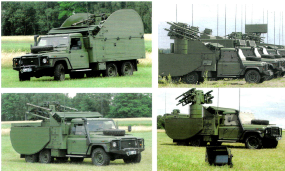
Fot. 11. Pojazd Huzar 4 x 6 Zintegrowanego Modułowego Rakietowo-artyleryjskiego Systemu Obrony Przeciwlotniczej Krótkiego Zasięgu KOBRA
