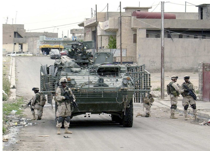
Rys 14. Transporter opancerzony Stryker z zamontowanymi ekranami przeciwkumulacyjnymi
