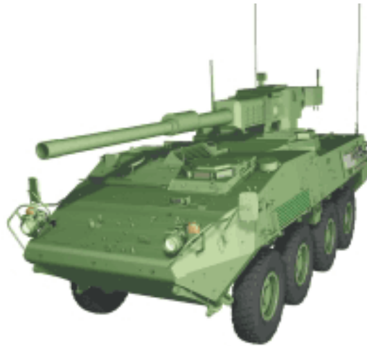
Rys. 13. Transporter opancerzony Strykem w wersji pojazdu wsparcia ogniowego z armatą 105 mm
