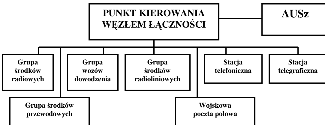
Rys.3. Struktura organizacyjno-techniczna WŁ SD BZ
