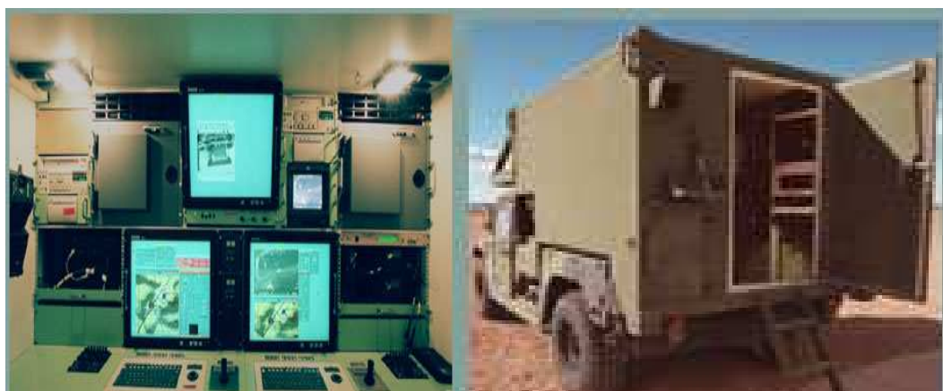
Rys. 5. Wnętrze nowej One System Ground Control Station, która ma służyć w założeniach do kontroli wszystkich bsl pozostających w gestii pododdziałów rozpoznania USArmy, co ma zwiększyć elastyczność i efektywność ich użycia
