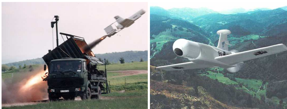
Rys. 1. Po lewej: start KZO z użyciem przyspieszacza raketowego, po prawej: Rheinmetall KZO/Prospector AI
