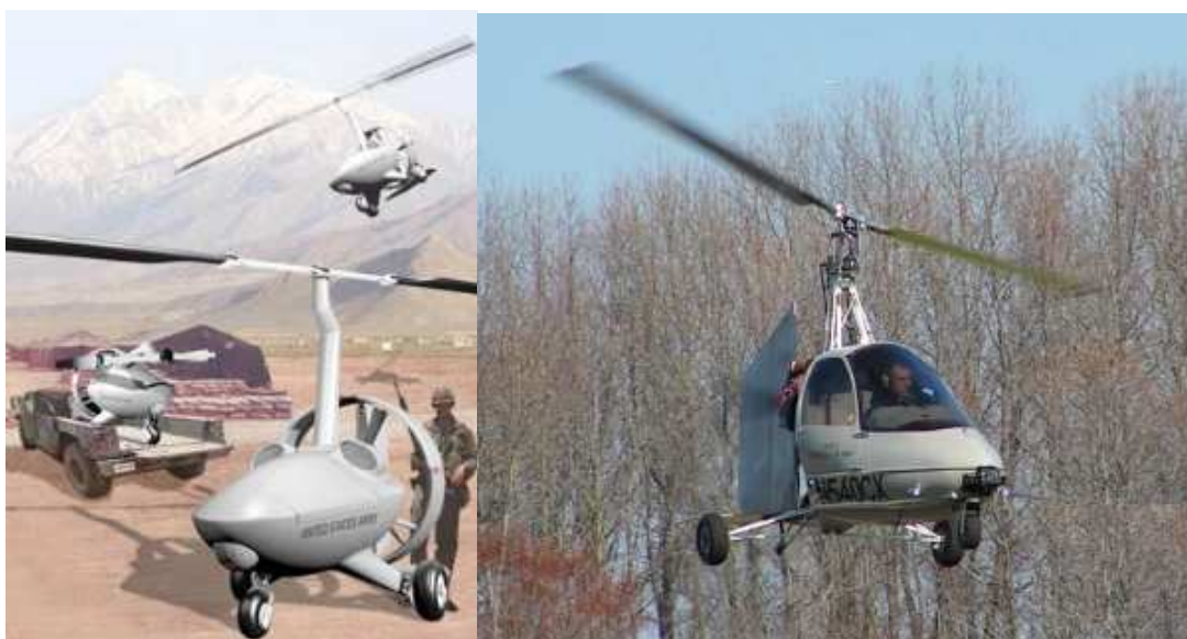
Rys. 6. Po lewej: Air Guard, po prawej: demonstracyjna wersja Air Guarda podczas testu lotu autonomicznego
