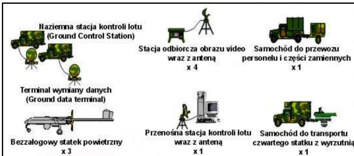
Rys. 2. Elementy składowe systemu RQ-7A Shadow200. Źródło: United States General Accounting Office, http://www.gao.gov
