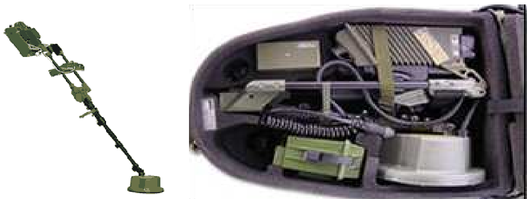
Fot. 2. Wykrywacz AN/PSS - 14 w stanie rozłożonym i złożonym
