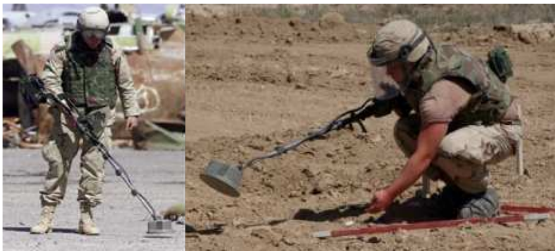
Fot. 1. Rozminowanie terenu wykrywaczem AN/PSS-14
