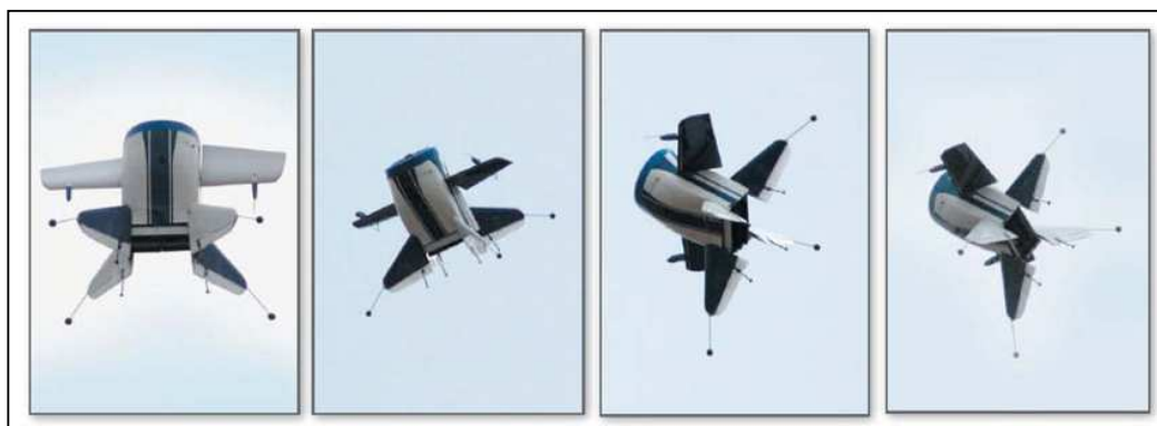
Rys. 5. GoldenEye 50 podczas przechodzenia z lotu pionowego do lotu poziomego
