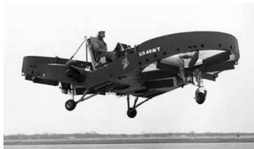
Rys. 4. Po lewej: prototyp Class II UAV Air Scout , po prawej: jego znacznie większy pierwowzór z 1962 r., model PA-59H AirGeep II
