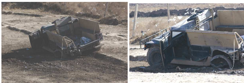
Fot. 6. Zniszczony pojazd HMMV po wjechaniu na minę przeciwpancerną YM - II
