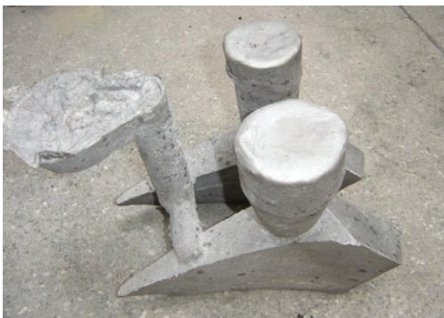
Rys. 12. Odlew po oczyszczeniu z masy
