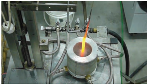
Rys. 3. Przebieg procesu mikrojetowego przesycania
