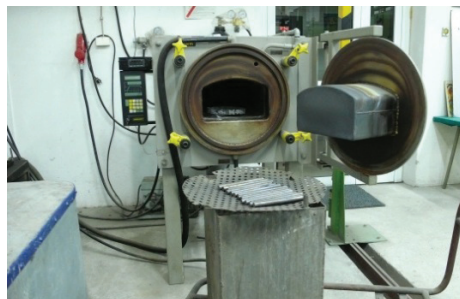
Rys. 4. Ogólny widok zastosowanego pieca do obróbki cieplnej wraz z próbkami do badań
