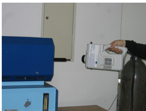
Rys. 4. Pomiar nosem elektronicznym
