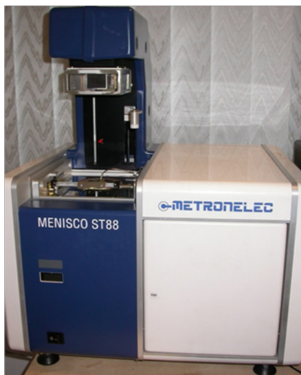
Rys. 2. Zestaw pomiarowy Menisco ST88 firmy Metronelec do badania lutowności metodą meniskograficzną
