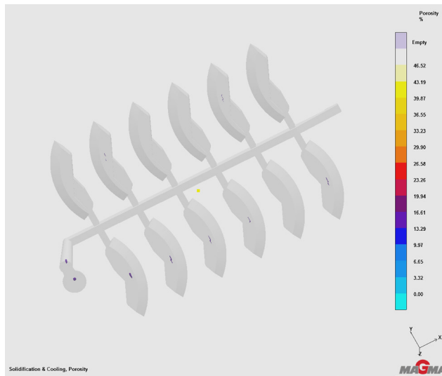
Rys. 6. Rozkład porowatości w odlewie redlicy dla bardzo dobrych parametrów grafityzacji
