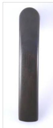
Rys. 15. Powłoka otrzymana w roztworze nr 1 w czasie 30 min
