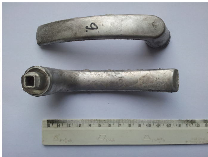
Rys. 1. Fotografie powierzchni odlewów klamki
