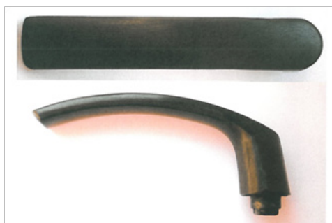
Rys. 13. Gotowe wyroby po obróbce wibrościerniej z wytworzoną w roztworze C powłoką chromianową
