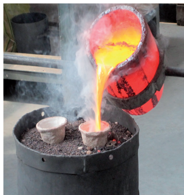
Rys. 18. Zalanie formy ceramicznej ciekłym brązem B555
