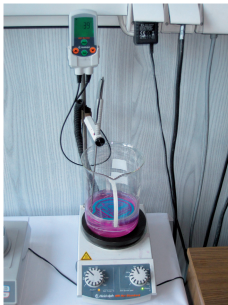
Rys. 10. Wyplukiwanie materiału podporowego z wydrukowanego modelu medalu przy pomocy mieszadła magnetycznego
