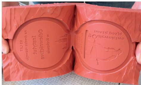
Rys. 15. Widok dwóch połówek gotowej matrycy
