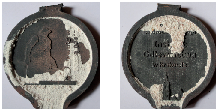
Rys. 20. Awers i rewers medalu okolicznościowego po odcięciu od układu wlewowego
