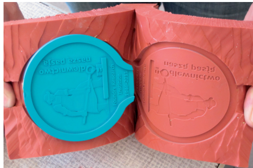
Rys. 14. Usunięcie wzorcowego modelu z gotowej matrycy
