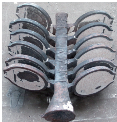
Rys. 19. Widok otrzymanego odlewu bezpośrednio po usunięciu ceramicznej powłoki
