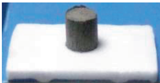
Rys. 2. Próbką popiołu na ceramicznej podstawie
