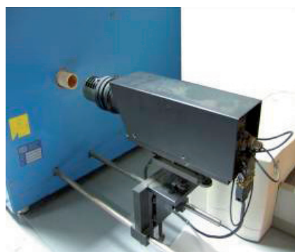
Rys. 4. Kamera rejestrująca obraz próbki
