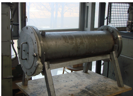
Rys. 4. Widok pieca komorowego do wstępnego wygrzewania preform
