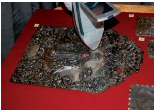
Rys. 8. Badanie składu stopu plakiety wotywniej, Jan Letyński, Toruń, 1748, (MT/S/2010), Ratusz, wystawa „Sztuka sakralna nowożytnego Torunia”. Numer pomiaru: 275
