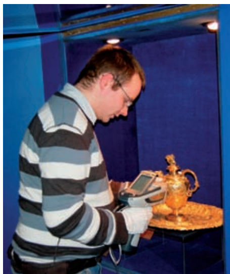
Rys. 4. Badanie składu stopu dzbana z augsburskiego kompletu do obmywania rąk (MT/S/1969/1; zob. rys. 2). Numery pomiarów: 192 i 193
