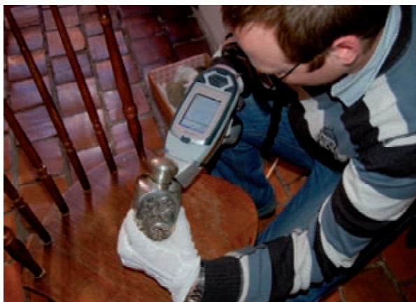
Rys. 7. Badanie składu stopu puszki na susz herbaciany, Jacob Jenny, Toruń, 1. ćwierć XVIII w., (MT/S/10402), Ratusz, wystawa „Dawny Toruń 1233–1793. Historia i rzemiosło artystyczne”. Numer pomiaru: 235
