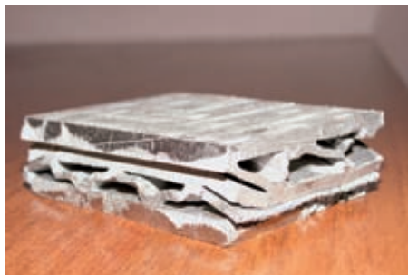
Rys. 13. Porównanie zgniecionej do 50% pierwotnej wysokości modelu numerycznego - a oraz odlewu struktury trapezowej - b
