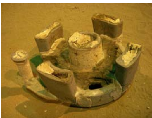
Rys. 21. Przykładowy odlew po wybiciu z formy i przed obcięciem układu wlewowego i zasilaczy
