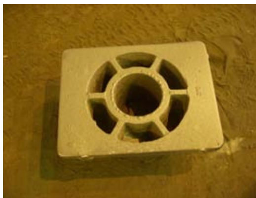
Rys. 22. Przykładowy odlew po odcięciu układu wlewowego i po oczyszczeniu
