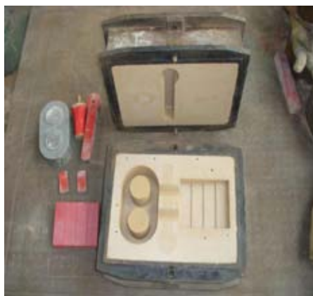
Rys. 1. Forma odlewnicza do wykonywania odlewu testowego (część dolna i górna) po zaformowaniu wraz z oprzyrządowaniem modelowym
