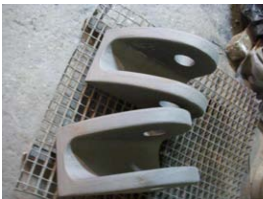
Rys. 20. Pierścień zimnego końca, staliwo LH25N7S2G2, masa odlewu - ok. 150 kg
