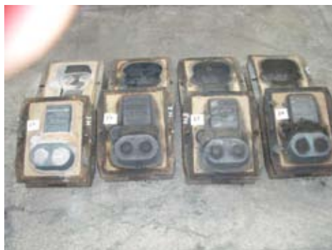
Rys. 2. Formy odlewnicze próby testowej wraz z odlewami po zdjęciu górnej skrzynki
