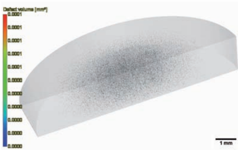
Rys. 6. Przestrzenny rozkład (3D) fazy zbrojącej w kompozycie ALFA25
