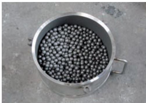
Rys. 2. Kule mielące (mielniki) z widoczną osadzoną na ich powierzchni warstwą kompozytu ALFA25
