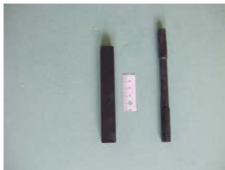
Rys. 15. Próbkki stopu Mg-Li-x o zawartości litu około 40% wag. Stop lżejszy od wody Fig. 15. The specimen of Mg-Li-x alloy containing about 40 wt.% lithium. Alloy lighter than water
