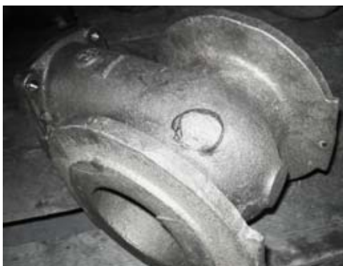
Rys. 5. Odlew korpusu zaworu
