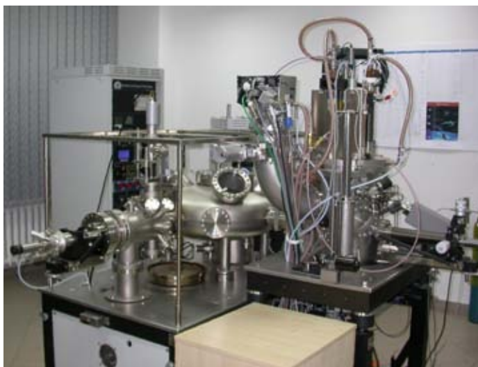
Rys. 3. Uniwersalny zestaw aparaturowy do kompleksowych badań właściwości ciekłych metali i stopów w wysokiej temperaturze opracowany w Instytucie Odlewnictwa [2]
