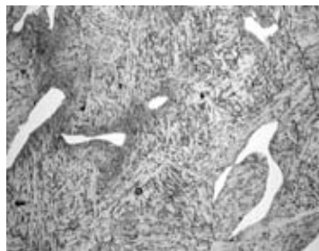
Rys. 2. Mikrostruktura próbki 1.1, zgląd traw. Mi5Fe, pow. 360x
