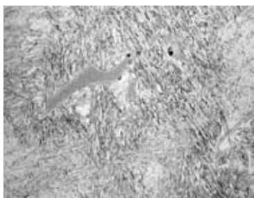
Rys. 3. Mikrostruktura próbki 3.1, zgląd traw. Mi5Fe, pow. 360x
