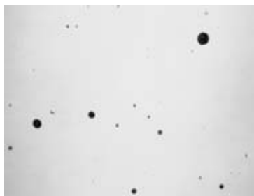
Rys. 1. Przekiętny obraz wtrąceń niemetalowych, pow. 360x
