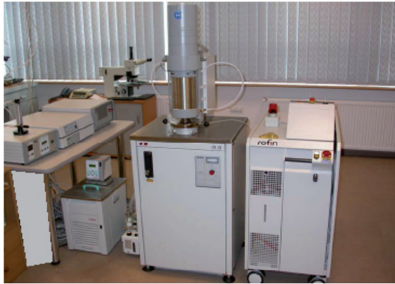
Rys. 5a. Zestaw aparaturowy typu LFA 427 służący do badań przewodnictwa temperaturowego stałych i ciekłych metali, stopów, materiałów ceramicznych oraz proszków, na którym zrealizowane były badania żeliwa sferoidalnego miedziowo-niklowego
