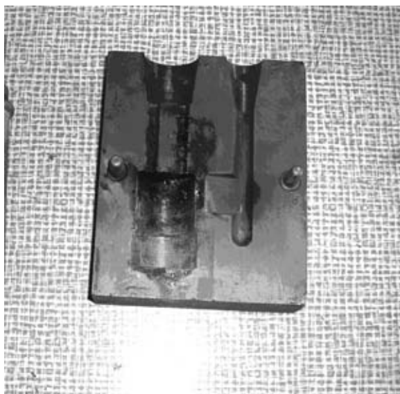
Rys. 1. Forma do badania zawartości wodoru i azotu
