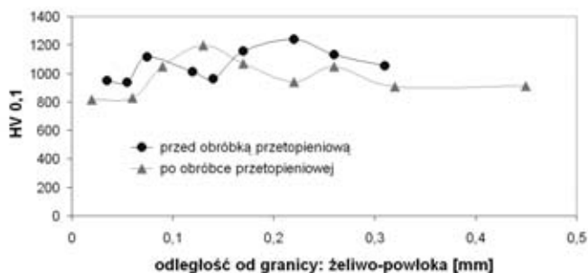
Rys. 4. Mikrotwardość powłoki Cr 3 C 2 -NiCr naniesionej metodą natrysku plazmowego
