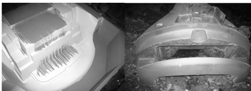
Fot. 5. Wnęka formy wykonana z masy ze spoiwem Rudal A oraz odlew balastu
