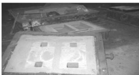
Fot. 3. Odlewy elementu wypełniającego wykonane w masie z udziałem spoiwa Rudal A
