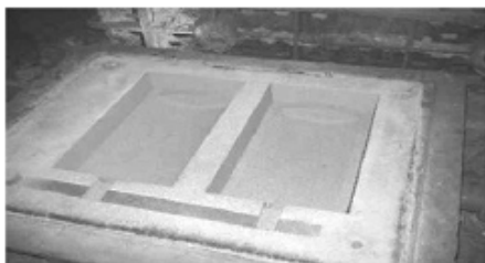
Fot. 2. Forma dla odlewu elementu wypełniającego przed złożeniem
