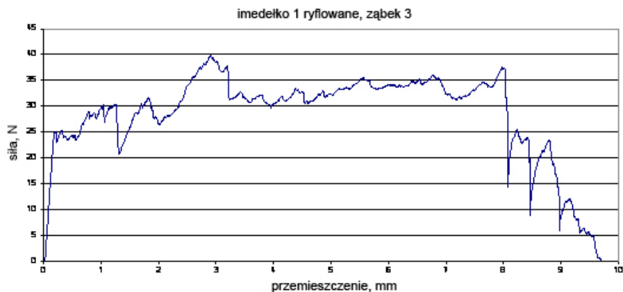
Rys. 6. Wykres zmian siły podczas wyciągania igły uchwyconej imadłem nr 1 z częścią chwytaną ryflowaną, pierwsza próba, ząbek nr 3
