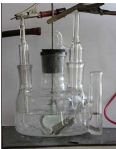
Rys. 8. Układ pomiarowy do badań korozyjnych
