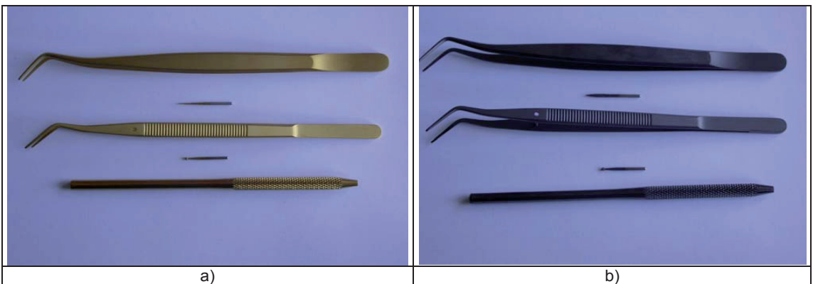
Rys. 2. Pincety, uchwyt do narzędzi stomatologicznych oraz wiertła stomatologiczne pokryte powłokami a) TiN i b) TiAlN
