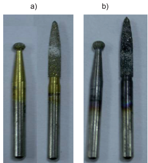
Rys. 4.4. Wiertła po 9 miesiącach eksploatacji a) pokryte TiN, b) pokryte TiAlN
