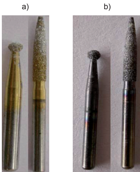
Rys. 4.3. Wiertła po 6 miesiącach eksploatacji a) pokryte TiN, b) pokryte TiAlN
