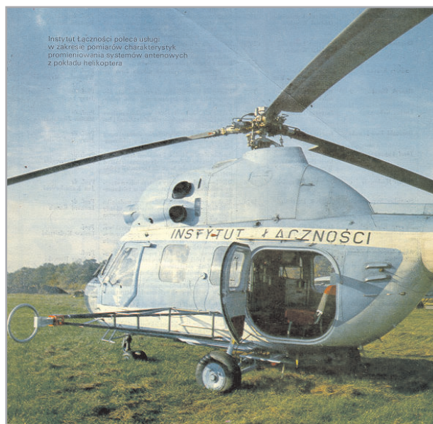
Rys. 2. Wielozadaniowe laboratorium kontrolno-pomiarowe na śmigłowcu
