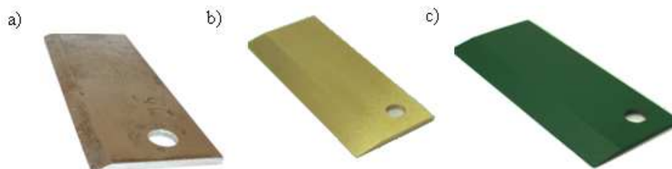
Rys. 3. Noże wykorzystywane do badań: a) nóż ze stali NC6, b) nóż z powłoką TiN, c) nóż z powłoką AS48
