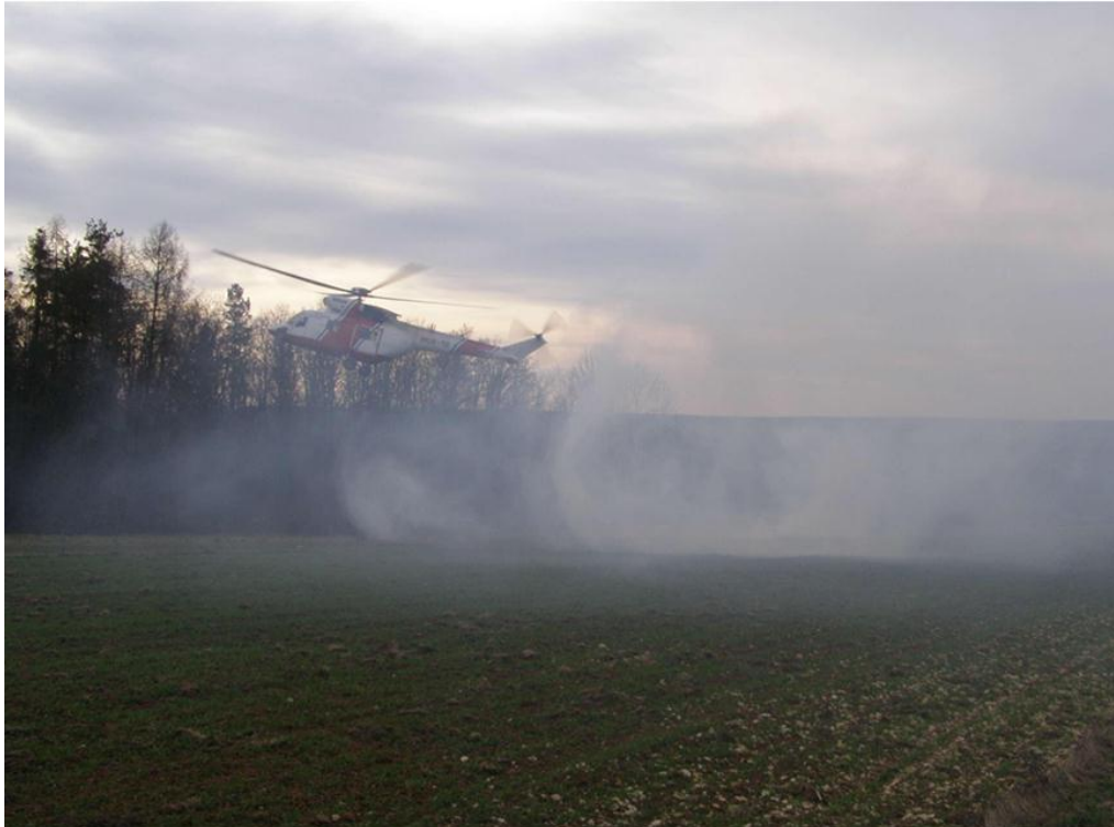
Rys. 10. Struktura strumienia zawirnikowego podczas badań eksperymentalnych na obiekcie rzeczywistym śmigłowca W3-A SOKÓŁ
