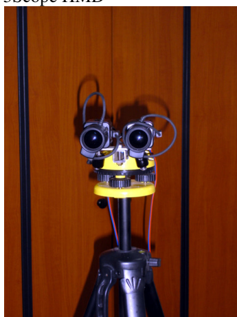
System akwizycji danych wizyjnych budowanego systemu zobrazowania przestrzennego
