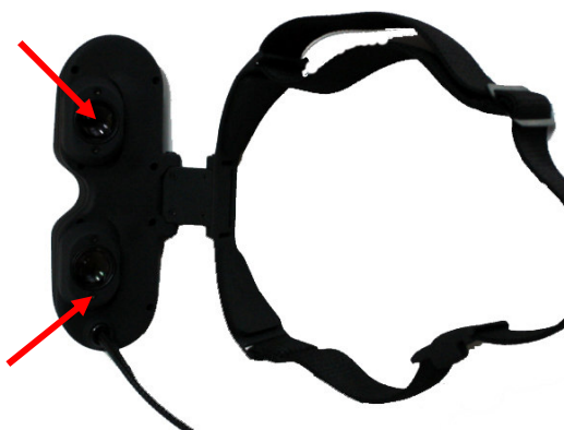
Rozmieszczenie wyświetlaczy ciekłokrystalicznych w goglach 3Scope HMD
