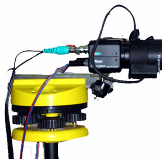
System akwizycji danych wizyjnych budowanego systemu zobrazowania przestrzennego
