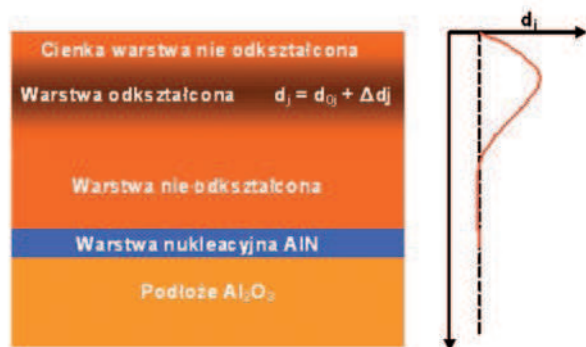
Rys. 2. Model odkształceń sieci krystalicznej powstałych na skutek implantacji jonowej przyjęty do symulacji rentgenowskich profili dyfrakcyjnych.
