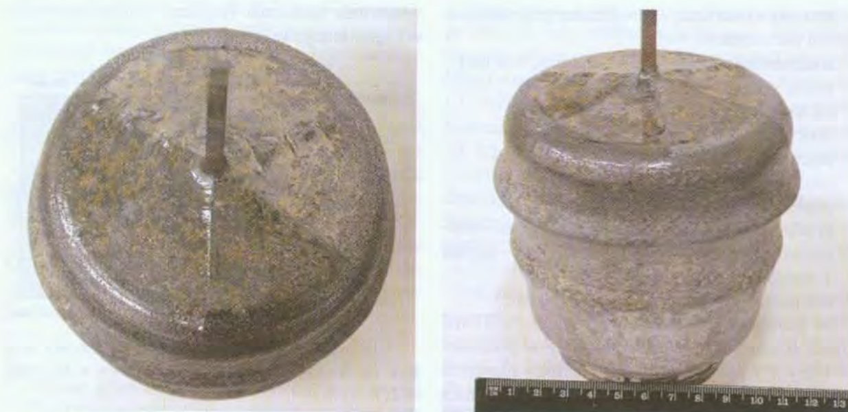
Rys. 9. Kryształ GaP nr 220 o orientacji \langle 111 \rangle po usunięciu z jego powierzchni topnika.
