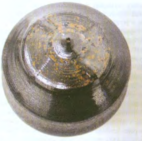
Rys. 8. Kryształ GaP nr 213 o orientacji \langle 100 \rangle . Fig. 8. Crystal GaP 213, \langle 100 \rangle oriented.
