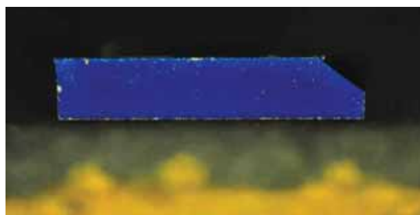
Rys. 3.4. Charakterystyki P-I (a) i spektralne (b) dla DL lutowanej przy pomocy Sn do chłodnicy Cu. Poniżej zdjęcie chipu od strony przedniego lustra.
