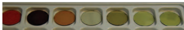
Rys. 19. Zdjęcia struktur epitaksjalnych Ni,Ge:GGG/GGG. Strzałka oznacza kierunek wzrostu stężenia GeO 2 w roztworze wysokotemperaturowym.
