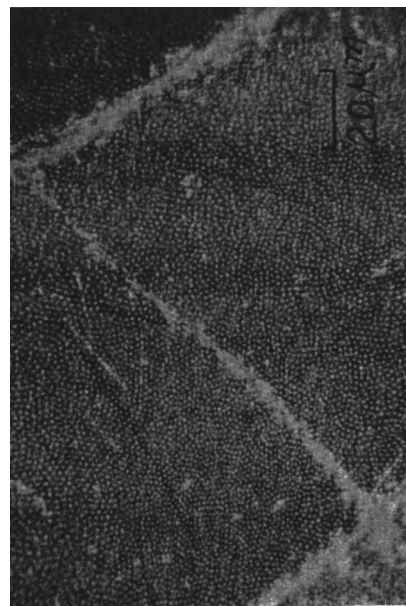
Rys. 13. Eutektyka \text{UO}_2 -Ta (12% wag Ta). Fig. 13. Eutectic \text{UO}_2 -Ta (12 wt% Ta).
