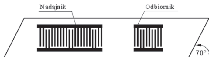
Rys. 2. Struktura linii opóźniającej na 41^\circ\text{YX LiNbO}_3 i 36^\circ\text{YX LiTaO}_3 Fig. 2. Structure of the delay line on 41^\circ\text{YX LiNbO}_3 and 36^\circ\text{YX LiTaO}_3 .
