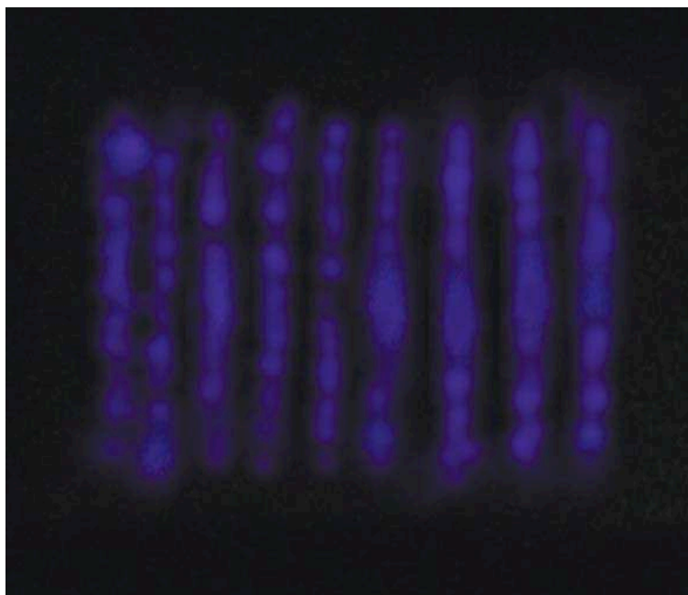
Rys. 6. Wyładowania na powierzchni kształtki: powietrze, wymiary rzeczywiste 34 \times 22 \text{ mm} ; czas ekspozycji 1 s.
