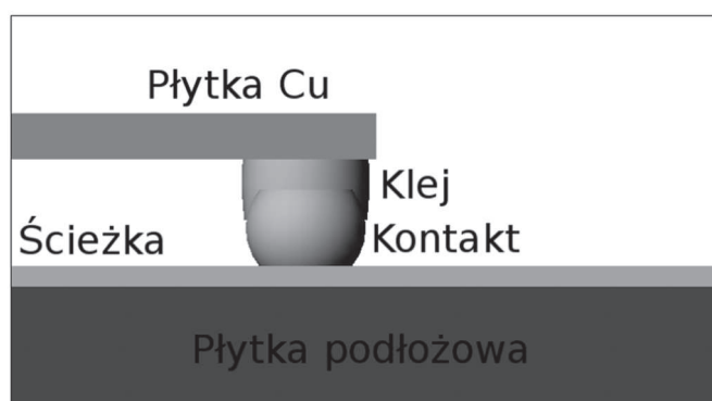
Rys. 3. Budowa obiektu z kontaktami częściowo ukrytymi. Fig. 3. Cross section of proposed (semi) flip-chip microjoint.
