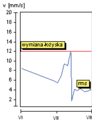
Rys. 18. Przebieg zmian wartości skutecznej prędkości drgań łożyska z zaznaczeniem czasu jego wymiany
