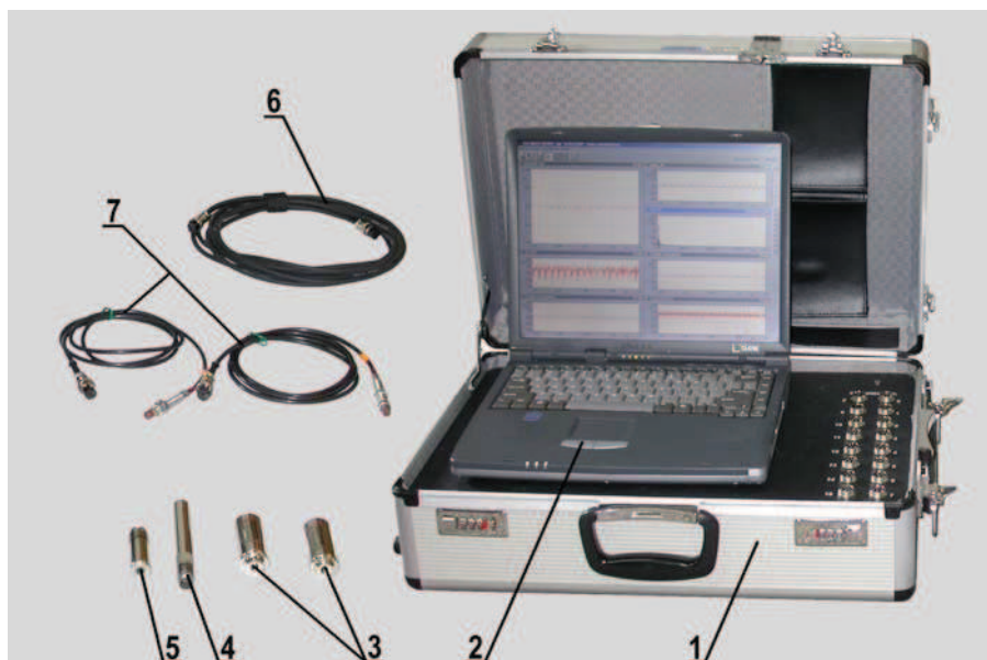
Rys. 2. Komputerowy analizator diagnostyczny KSD-400 1 – walizka z kartami przetwornikowymi, 2 – notebook , 3 – czujniki indukcyjne drgań, 4 – czujnik " foto ", 5 – czujnik piezoelektryczny, 6 – przewody, 7 – czujniki wiroprowadowe z przewodami
