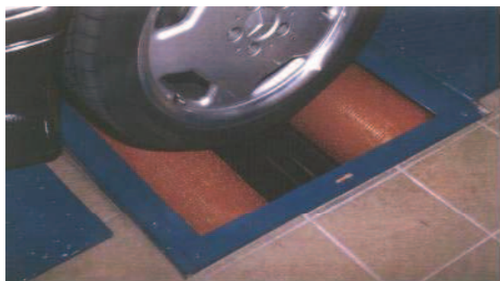
Rys. 2. Pojazd na urządzeniu rolkowym IW2 EUROSYSTEM firmy MAHA.
