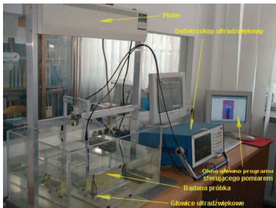
Rys. 1 Stacjonarne stanowisko defektoskopii ultradźwiękowej
