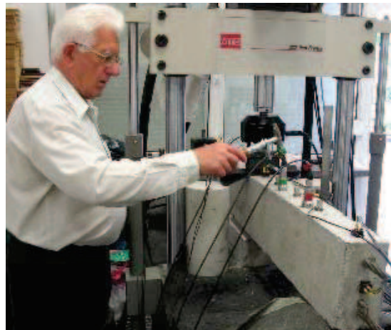
Rys.2. Testowanie belki z betonu sprężonego prowadzono po każdym kroku zwiększenia obciążenia statycznego i stopniowo postępującej degradacji struktury (pęknięcia).
